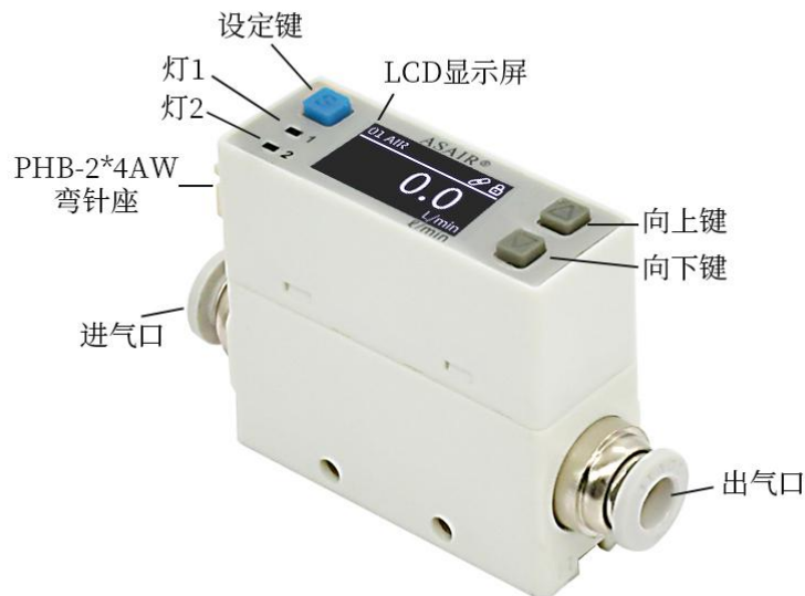
图 2. AFM07 系列结构示意图
